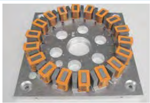
Die Elektromaschine ist einfach herstellbar: Die U-Joche für den Eisenkreis können aus Standard-Kernblechen hergestellt werden, die Spulen der Statorwicklung werden einfach aufgesteckt. © Hochschule Landshut
