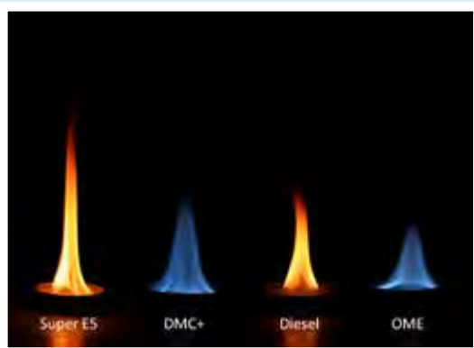
Die synthetischen Kraftstoffe DMC+ und OME verbrennen deutlich rußärmer als Super E5 und Diesel.
