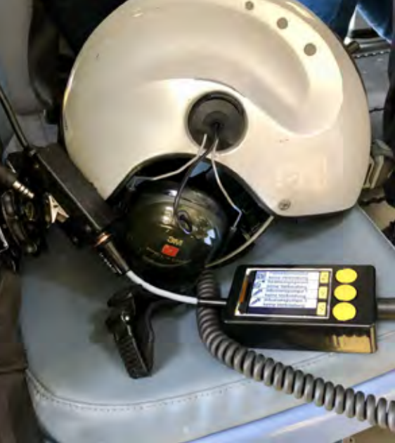
Abbildung des Alarmhub-Prototypen mit Anbindung an die Interkom-Anlage und den Helm. © GPP Communication GmbH & Co. KG
